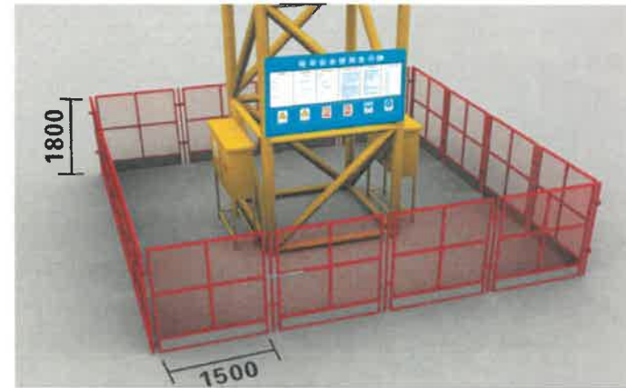
塔吊基础防护及告示牌 参考图例1-5-1
