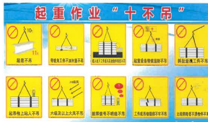
起重吊装“十不吊”公示牌 参考图例1-5-15
