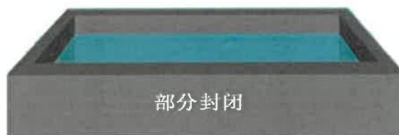
（b）部分封闭有限空间
